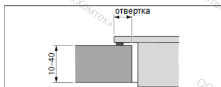
Рис. 11.8 Размеры нахлеста для накладного монтажа
