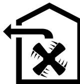
Zassane powietrze jest oczyszczone przez filtr przeciwłuszczowy i kierowane na zewnątrz poprzez system rur.
