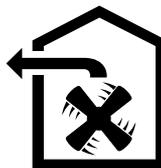
Втянутый воздух очищается жировоулавливающим фильтром и подаётся по системе труб наружу.
