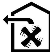
Emilen hava, yağ filtreleri tarafından temizlenir ve bir boru sistemi üzerinden dışarı iletılır.
