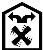
Nasátký vzduch se čistí pomocí tukového filtru a aktivního uhlíkového filtru a přivádí se zpět do kuchyně.
