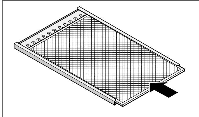
**3** Установите металлический жироулавливающий фильтр фиксатором вперёд в нижней части прибора и защёлкните фиксатор.
